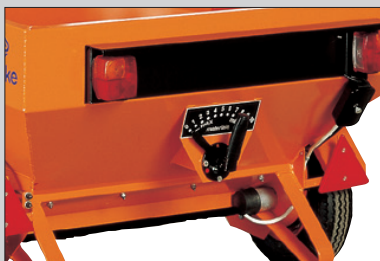
Die Streumenge wird mithilfe des Handgriffs justiert, der die Federbodenregelung steuert.
