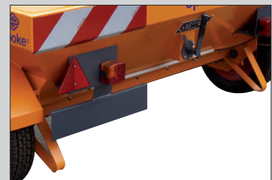
Eingebaute Stützfüße vereinfachen das Absetzen und Schleppen.
