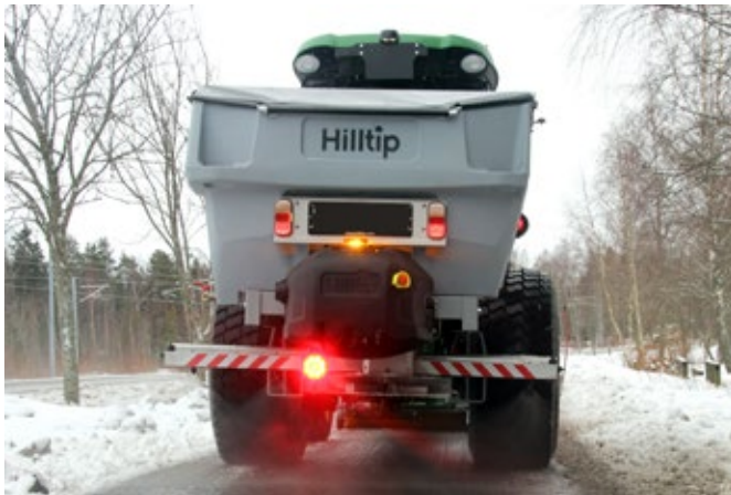
LED Arbeitsscheinwerfer (rot) und Warnlicht (orange)
