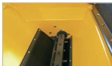
Das Epoke Dosiersystem: Umrührer, der evtl. Klumpen zerkleinert, und Auslegewalze für Dosierung.
