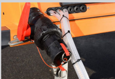
Zentral platzierte Befüllkupplung.
