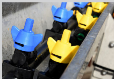
Strahldüsen mit Rückschlagventilen gewährleisten ein optimales Streubild in einer Breite von 1 bis 5,75 Metern.
